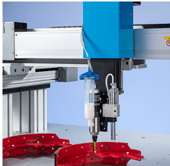
Otomotiv fren kaliperi üzerine gres uygulayan GV robotuna monte edilmiş 725D.
