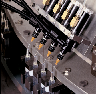
741V valfler, medikal üretim döner tablası üzerinde UV ile kürlenmiş malzeme uygular.
