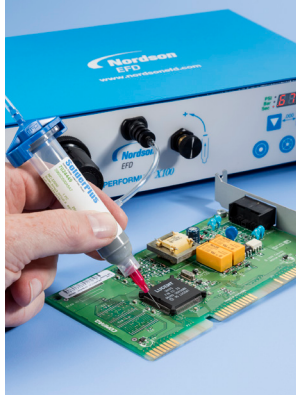
PCB kartları üzerine SolderPlus® lehim pastası uygulanması.
