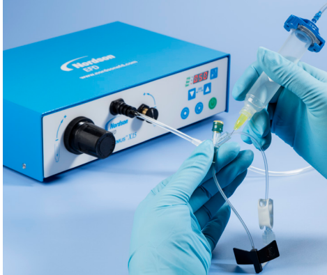
Medikal cihazlar üzerine düşük viskoziteli solvent uygulanması.
