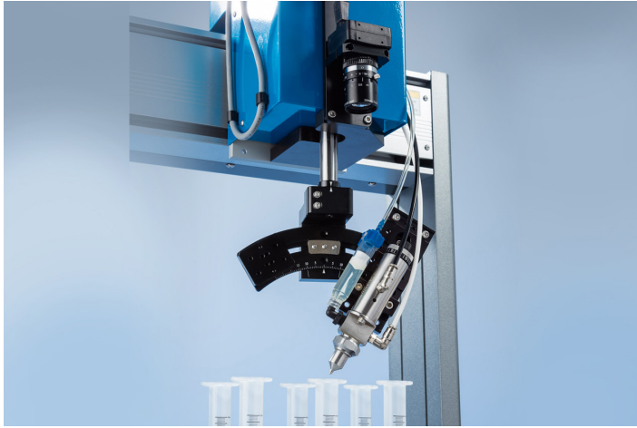
Akıllı CCD kamera, iş parçasının varlığını ve yönünü doğrular.
