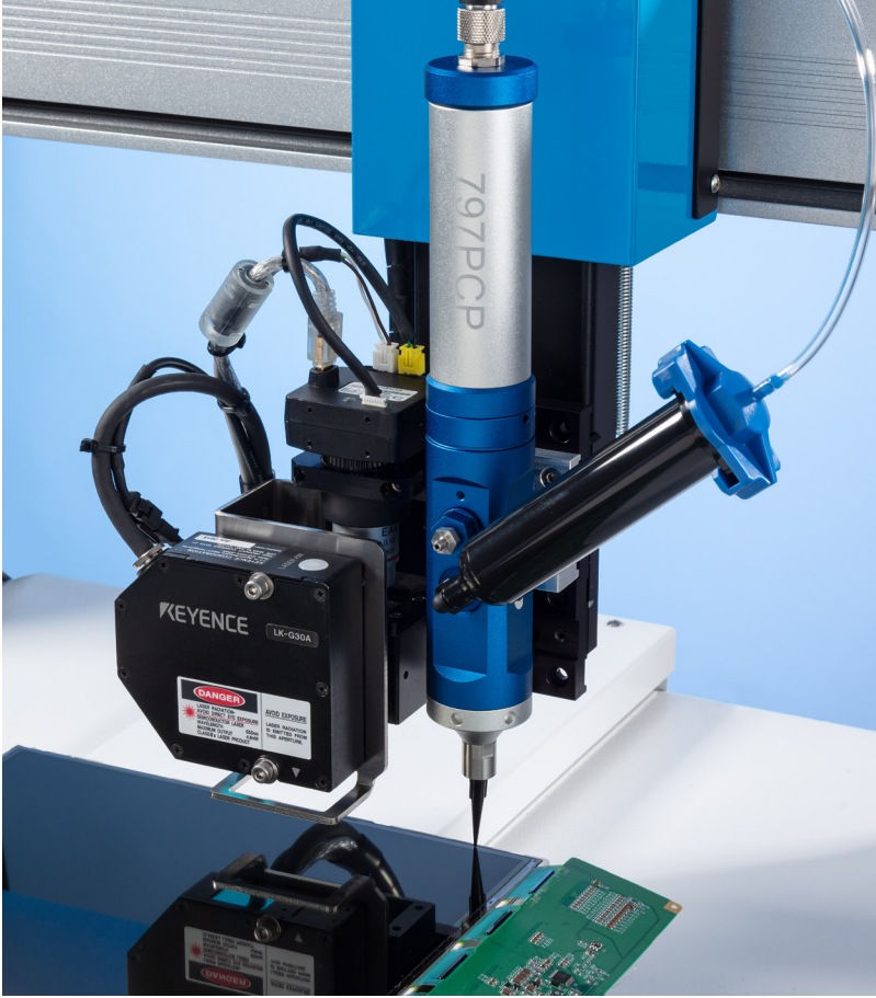
797PCP progressive cavity pompası, \pm 1\% doğrulukla sınıfının en iyi depozite hacim hassasiyeti ve tekrarlanabilirlik sağlar.
